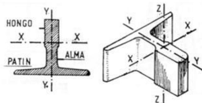
Las caras del hongo serán planas, lisas y mecanizadas. Otras secciones de riel pueden usarse siempre que el módulo o el momento resistente estén cubiertos y sea suficiente para soportar los esfuerzos previstos.
