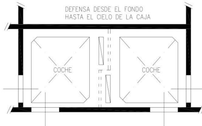
El peso total del contrapeso (bastidor más lastre) debe ser igual al peso  $P$  del coche más un exceso variable comprendido entre 0,40 y 0,50 de la carga máxima  $C$  que el coche puede transportar:
